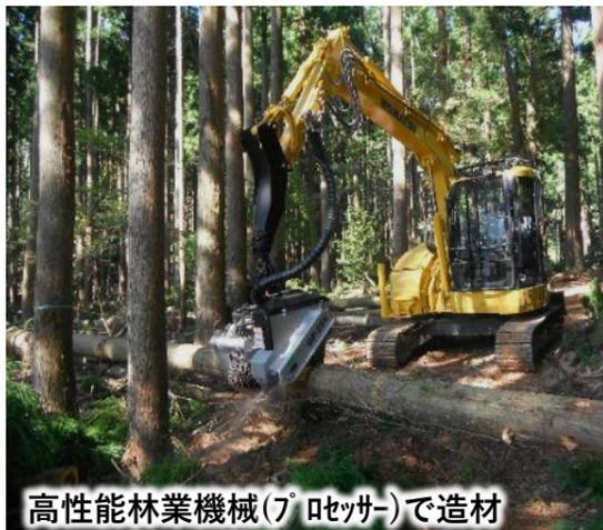
高性能林業機械(プロセッサ)で造材
